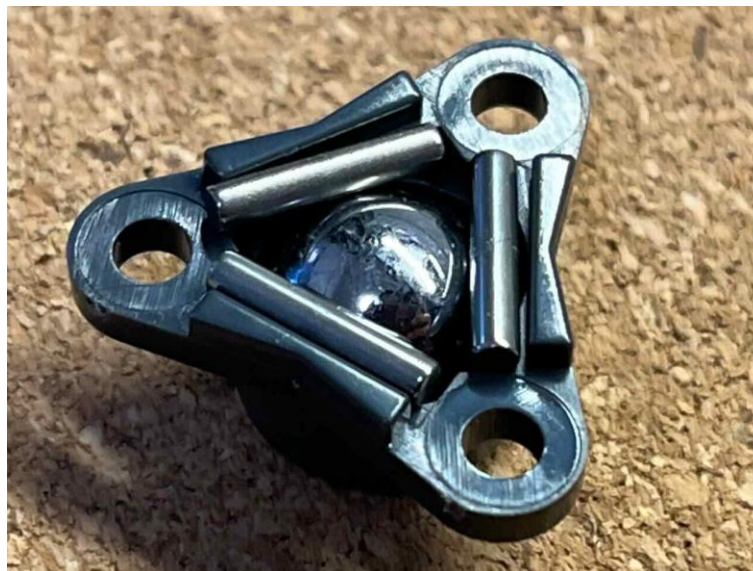
H3パーツにボールとシャフトをおきます。 シャフトがういています。
