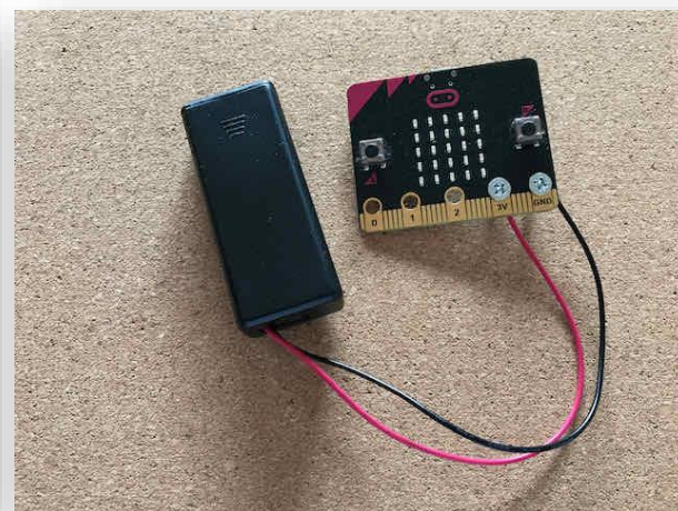
他の部品と電源を共用したり、他の部品から電源をとる場合は大きい3V, GND端子をつかいます
